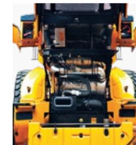
El **capó del motor se inclina hacia atrás por completo** y puede ser **abierto eléctricamente** para facilitar el acceso al compartimento del motor y al compartimento de enfriamiento sellados. El compartimento del motor está diseñado para evitar la posibilidad de incendios causados por la entrada de materiales extraños.
