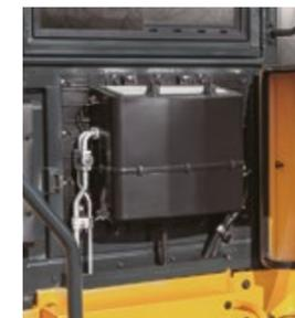
El **filtro de aire acondicionado** es fácil de sustituir y está hecho de un material especialmente seleccionado para un mayor rendimiento.
