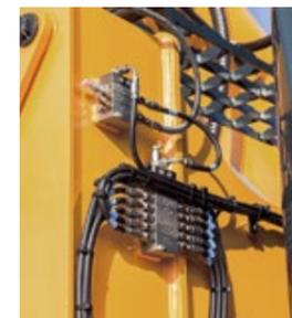
Con el **sistema de engrase automático** opcional, se aplica grasa a los puntos de lubricación automáticamente cuando se necesita. Se garantiza la dosificación correcta y que el lubricante sea aplicado uniformemente, reduciendo el consumo de grasa y eliminando los desperdicios.
