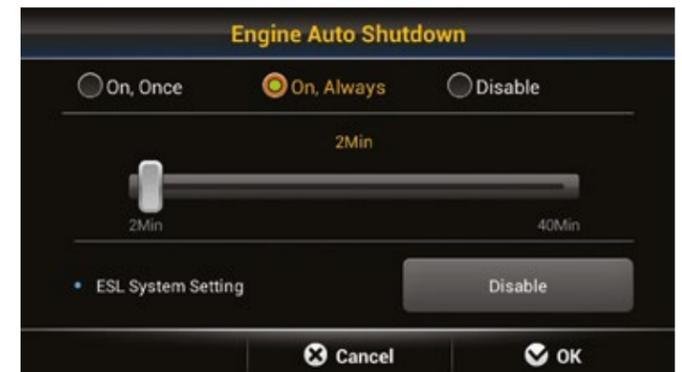
El **motor se apaga automáticamente cuando la máquina esté en reposo** para reducir el consumo de combustible y evitar emisiones innecesarias. Pueden seleccionarse diferentes modos de operación y tiempos de ralentí según el entorno de trabajo, mejorando aún más la eficiencia.
