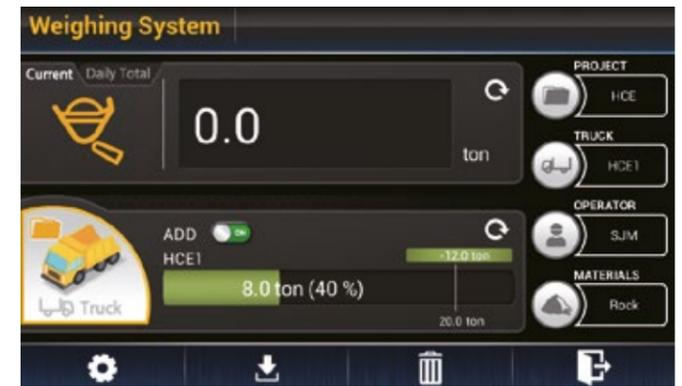
El **sistema de pesaje acumulativo automático/manual** de alta precisión le ayuda a gestionar la producción de forma más eficiente en cualquier entorno. Para una máxima precisión, en el monitor aparecen iconos de error de pesaje y un indicador de valor de peso de dos colores.
