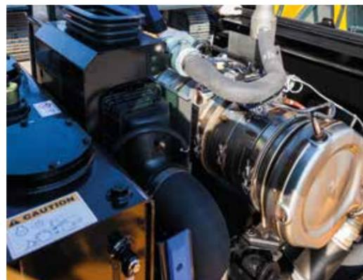
El **duradero sistema de postratamiento** está protegido por un soporte robusto y un sistema de absorción de impactos. De este modo se evitan los fallos debidos a golpes y vibraciones durante el funcionamiento.
