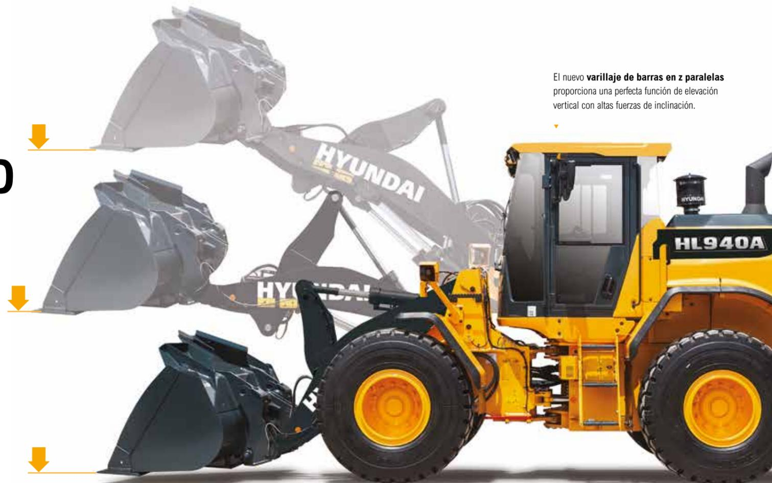
El nuevo **varillaje de barras en z paralelas** proporciona una perfecta función de elevación vertical con altas fuerzas de inclinación.
